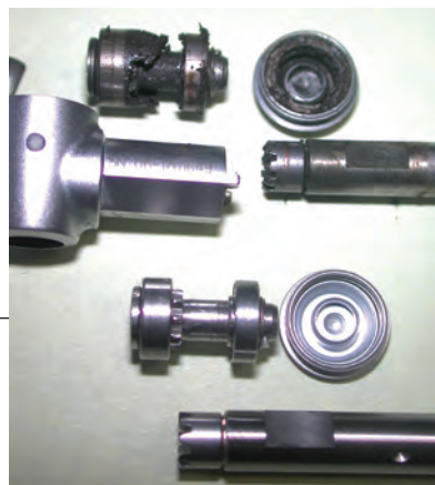
Un confronto tra ingranaggi testina nuovi ed ingranaggi testina danneggiati da paste abrasive (utilizzo errato della strumentazione)
