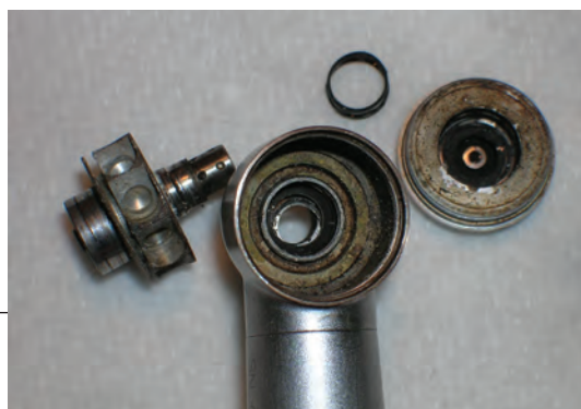
Interno turbina danneggiato da errata manutenzione: scarsa lubrificazione della strumentazione)
